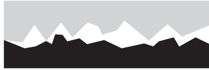
Cihaz ile soğutucu tabanı arasındaki hava boşlukları, iletim yolunu olumsuz etkiler
